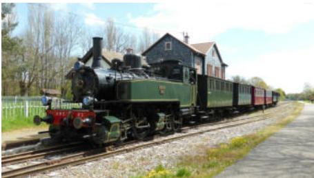
Schmalspurbahn in Frankreich mit einer Spurweite von 700 mm.
